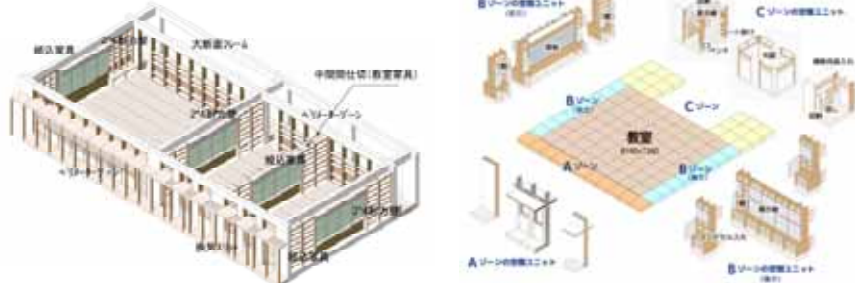
910 モジュールによる内部空間のユニット化
