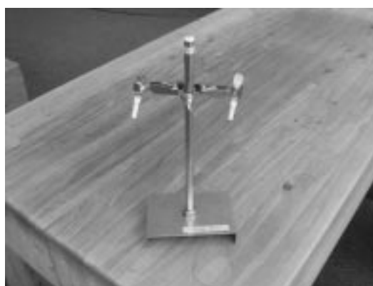
写真-2 パッシブサンプリングの様子
