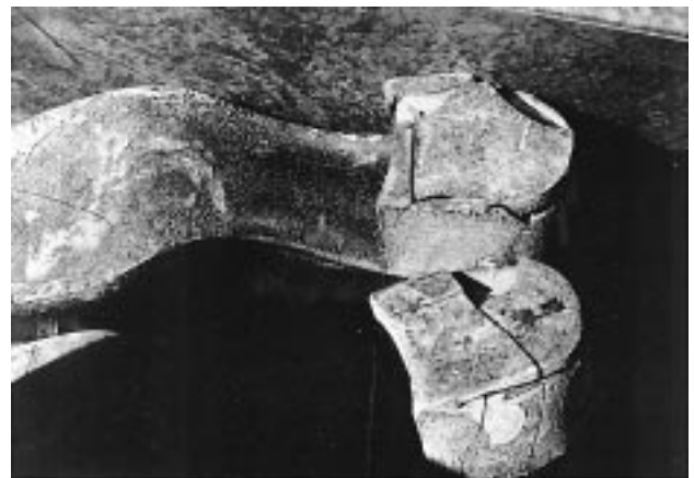
写真-1 PU製靴底にかびが育成し崩壊した様子
